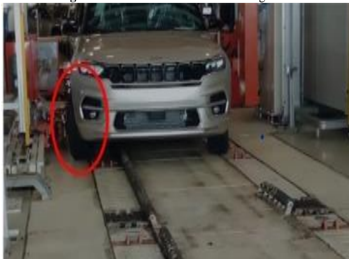
Figura 5 – Desalinhamento de Convergências
